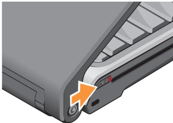
Para encender el conmutador inalámbrico, deslícelo de la parte posterior a la anterior del ordenador hasta que se oiga un clic.
